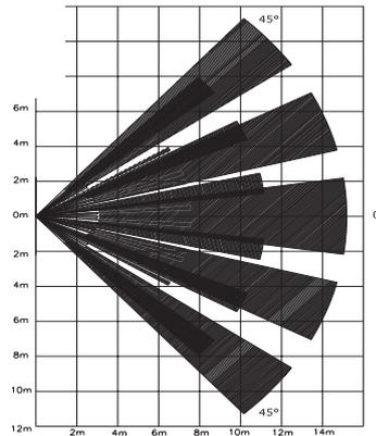
**SMILE 19** permette una copertura di 15 mt, la speciale conformazione della lente permette un'apertura orizzontale di oltre 90° con 29 fasci su 5 livelli
