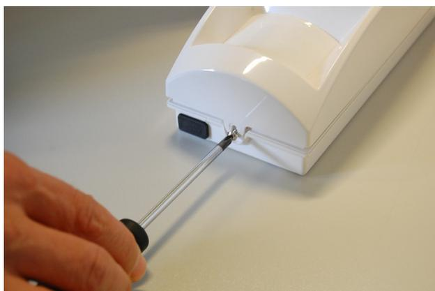
Rimuovere la scheda, praticare un foro sul fondo della cover inferiore per il passaggio dei cavi nella posizione idonea all'installazione. Praticare altri 2 fori per il fissaggio a muro del sensore, si consiglia di usare tasselli di misura non inferiore a 3mm.
