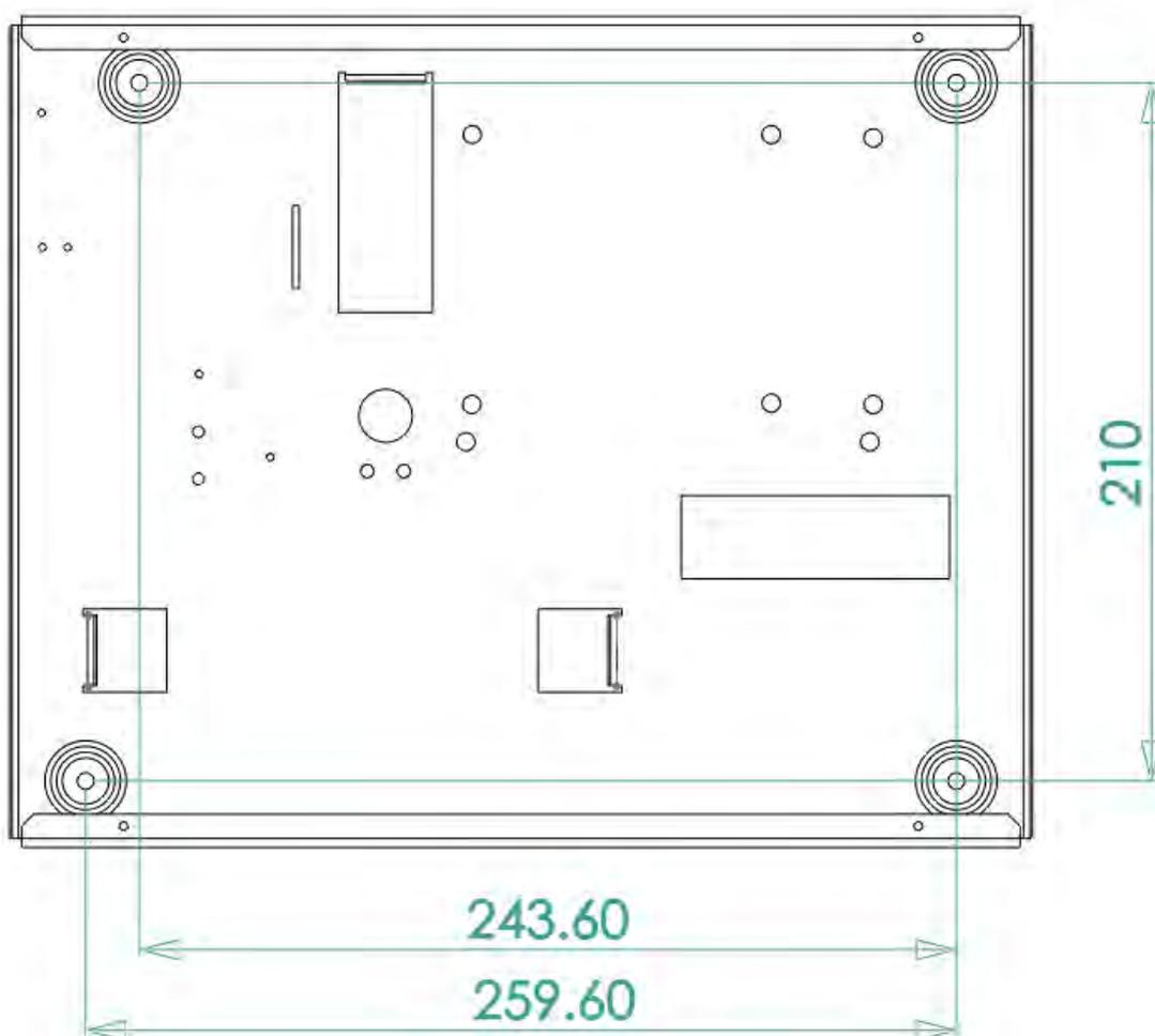
**BOX METALLICO PER BATTERIA 17AH**
