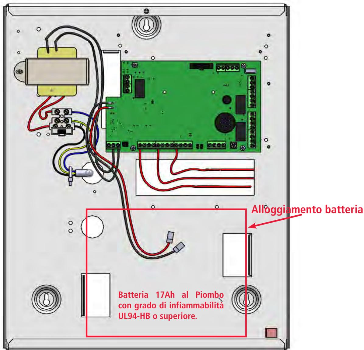
**Importante:** utilizzare del biadesivo sotto la batteria, per fissarla ed evitare vibrazioni.
