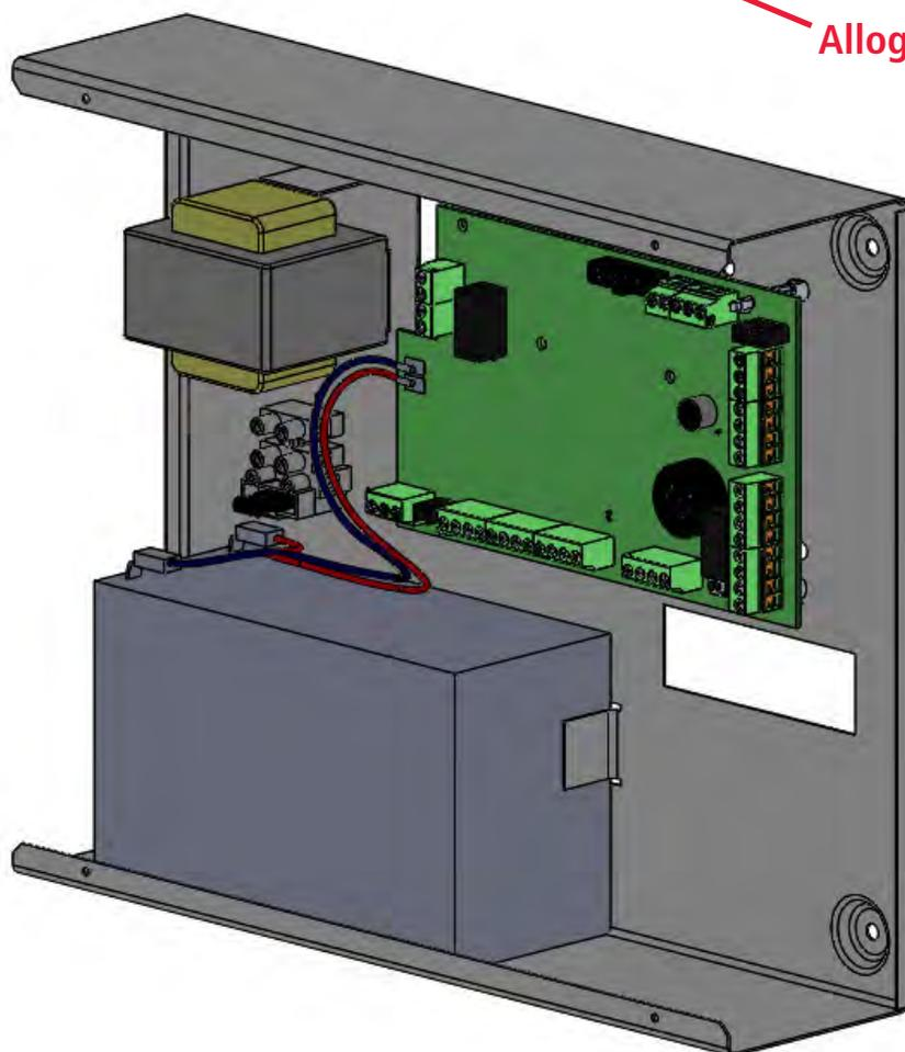
Importante: utilizzare del biadesivo sotto la batteria, per fissarla ed evitare vibrazioni.
