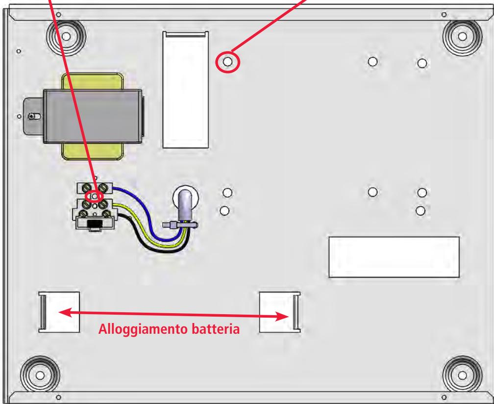
Per il collegamento di terra del coperchio di chiusura, effettuare il collegamento del cavo di terra al coperchio tramite apposito faston
