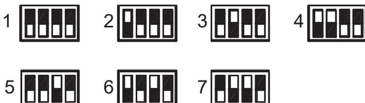
N.B.: in CONFIGURAZIONE 1 TUTTI I DIP IN OFF
