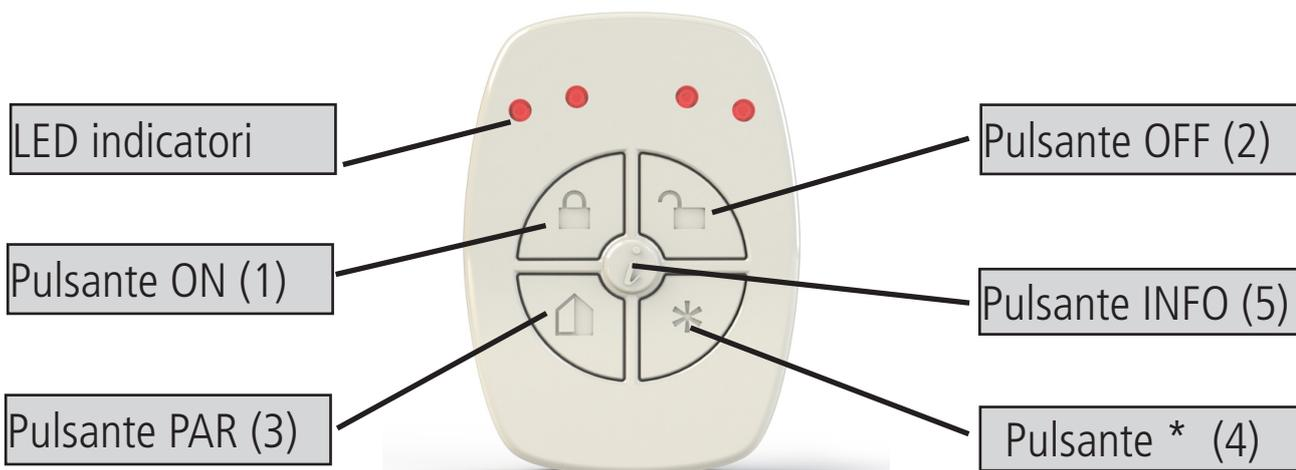
Il Telecomando, una volta memorizzato, tramite codice ID, oppure nel menù apprendimento premendo simultaneamente i Pulsanti ON(1) e PAR(3) per 2 secondi, è già pronto e programmato per:
