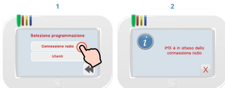
Toccando l'opzione “Connessione radio” (Fig. 1), la centrale viene mandata immediatamente in modalità “programmazione via radio”.
