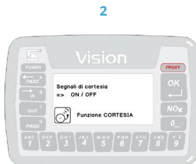
Viene visualizzato lo stato attuale di "attivazione" (**ON**) o "disattivazione" (**OFF**) della funzione cortesia.
