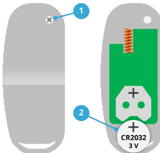
Per la sostituzione della batteria:
