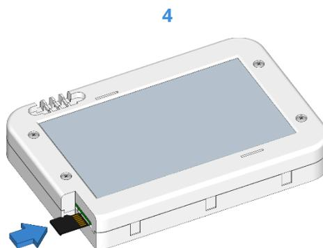
Re-inserire la scheda SD nel terminale. Quando il terminale sarà a riposo visualizzerà in sequenza le immagini.
