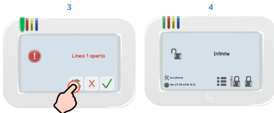
Una volta inserito il codice, possono essere notificati **gli allarmi** e le anomalie registrate dalla centrale (es.: linee aperte, assenza alimentazioni, linee escluse...). Toccare OK per confermare (se vi sono più notifiche si passa alla prossima) oppure NO per annullare la disattivazione del sistema.
