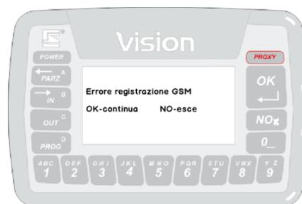
Possono essere notificate delle anomalie registrate dalla centrale (es.: linee aperte, assenza alimentazioni, linee escluse...).
