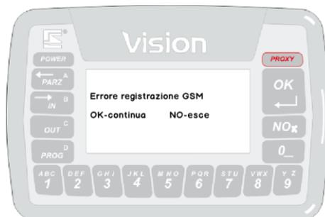
Una volta inserito il codice, possono essere notificate delle anomalie registrate dalla centrale (es.: linee aperte, assenza alimentazioni, linee escluse...).
