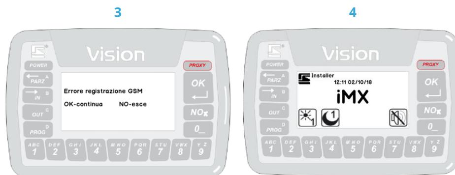
Una volta inserito il codice, possono essere notificate delle anomalie registrate dalla centrale (es.: linee aperte, assenza alimentazioni, linee escluse...).
