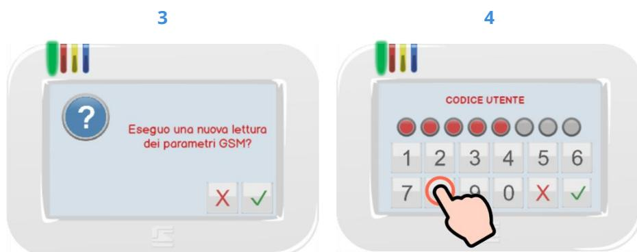
Viene chiesto se si desidera visualizzare i parametri memorizzati (toccare ) oppure eseguire una nuova verifica dei paramteri (toccare , in questo caso è necessario digitare il codice utente abilitato).
