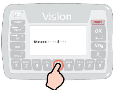
Selezionare/deselezionare il Programma da attivare, premendo i tasti numerici da 1 a 8.
