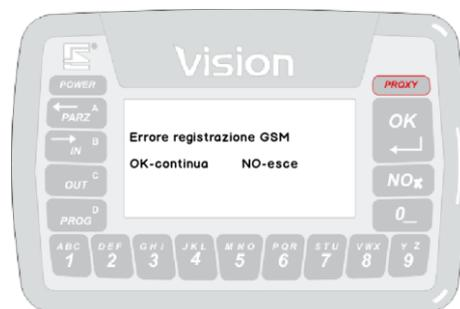
Possono essere notificate delle anomalie registrate dalla centrale (es.: linee aperte, assenza alimentazioni, linee escluse...). Passare di nuovo la chiave o premere **OK** (OK) per confermare (se vi sono più notifiche si passa alla prossima) oppure **NO** (NO) per annullare l'attivazione del sistema.
