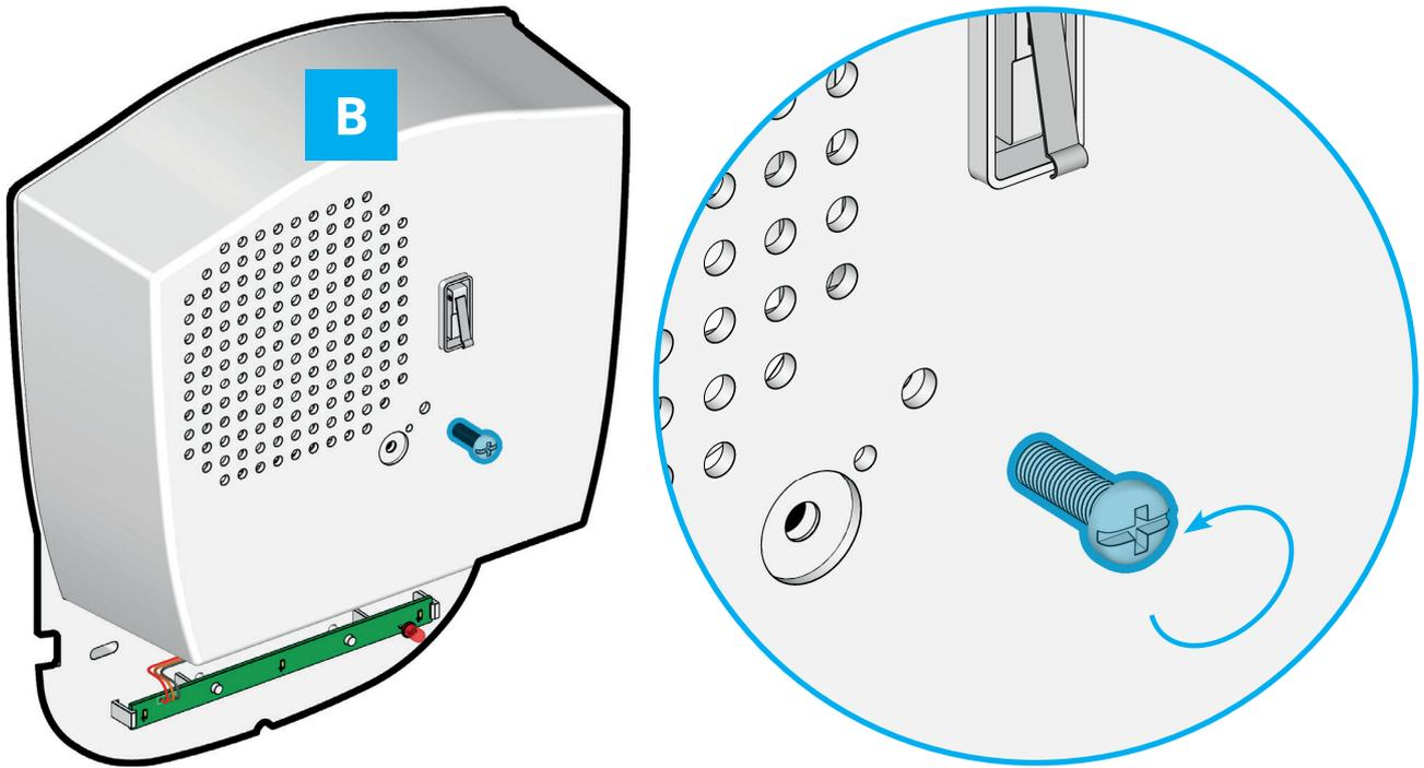
3. Svitare la vite di ritegno dello schermo di protezione interno ( ).
