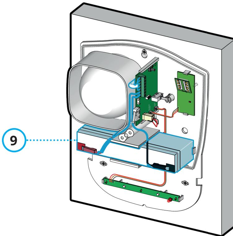
Inserire una batteria al piombo 12 V / 2 Ah nell'apposito alloggiamento (9).
