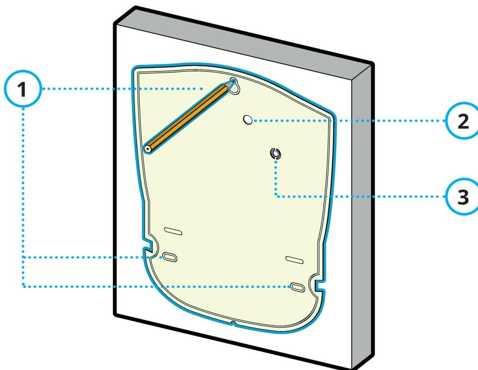
Utilizzare la dima in dotazione per segnare sulla parete la posizione: dei tre fori di ancoraggio (1), del punto di ingresso dei cavi di collegamento (2) e del punto di appoggio del tamper anti-asportazione (3). Rimuovere la dima.
