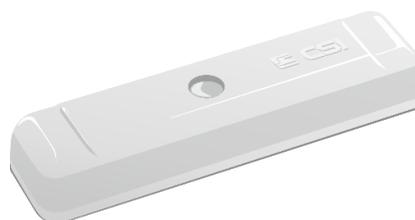
Rivelatore multifunzionale, accelerometrico su tre assi (x, y, z) con contatto magnetico per porte/finestre. Adatto alla rilevazione inerziale di movimento (tapparelle, porte scorrevoli). Comunicazione via radio WLink.
