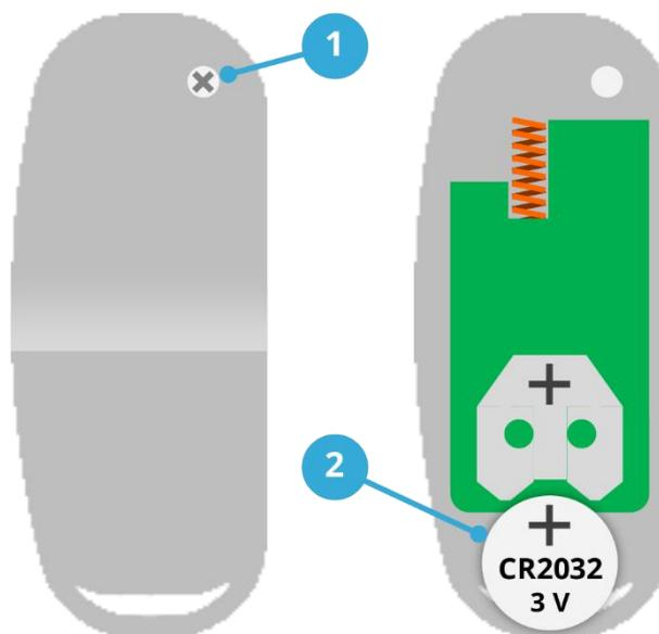
Per la sostituzione della batteria:
