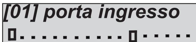
*Nella figura sopra, sono stati bloccati gli ingressi 1 e 12 (quelli con il quadrato). Quindi se risultassero non pronti non sarebbe possibile armare l'impianto, per poterlo armare è necessario portare a riposo gli ingressi.*
