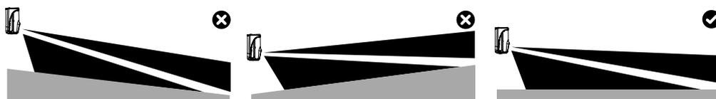
**Figura 3: Installazione su una superficie piana**
