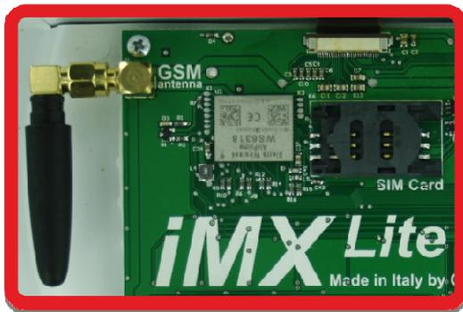
Questo particolare modello è caratterizzato dalla presenza del comunicatore MultiConnect su scheda (built-in). Non è pertanto richiesta l'installazione del MultiConnect, né è possibile, in quanto non presente l'apposito connettore. Per lo stesso motivo, non è possibile l'installazione del comunicatore Pstn TelCom.
