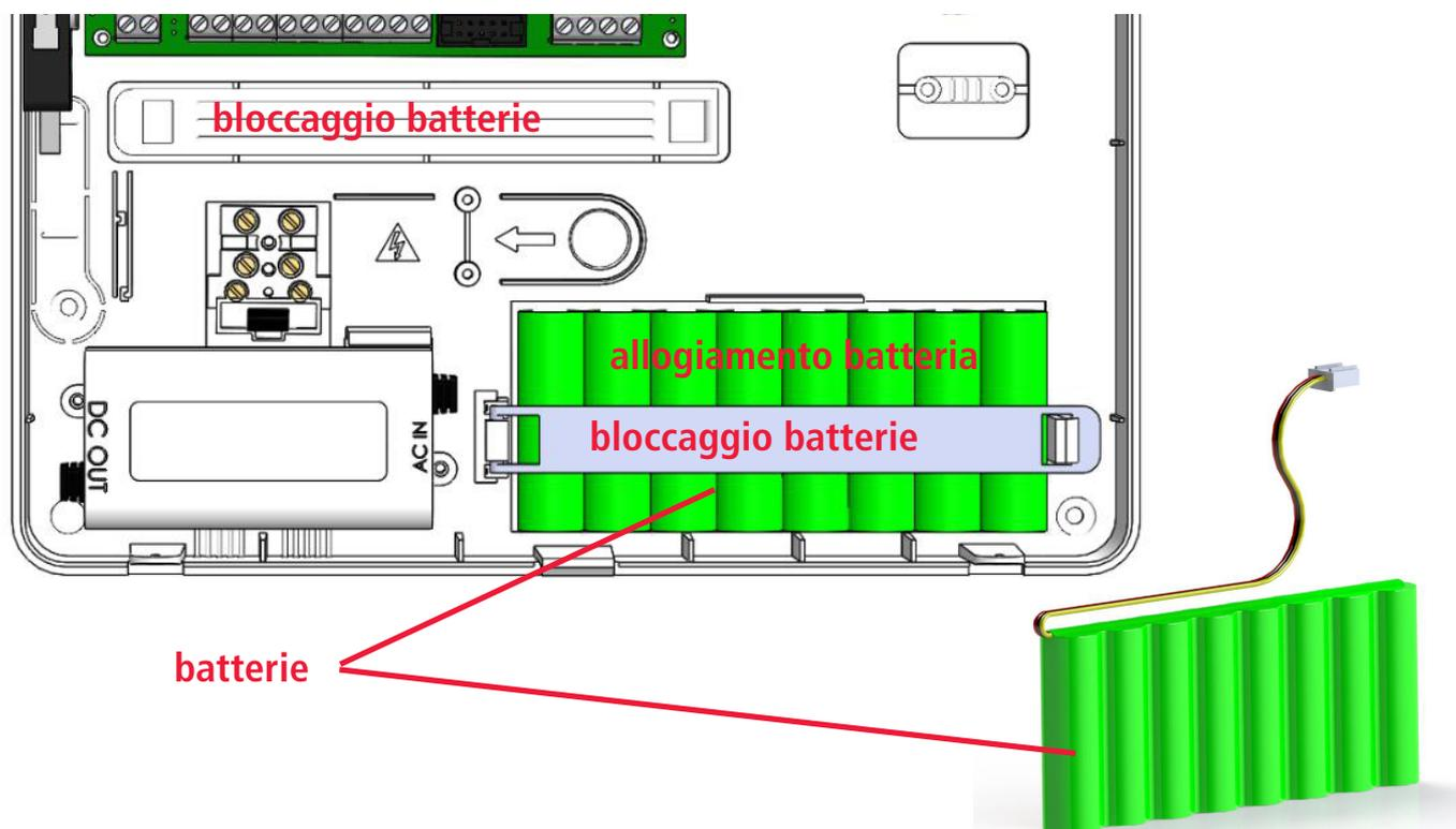
Dopo aver posizionato il blocco batterie nell' sete, bloccarlo con l'apposita linguetta "bloccaggio batteria" staccabile dal box plastico.
