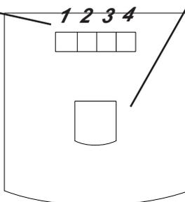
Led di cortesia, notificano la lettura della chiave e rimangono accessi ad indicare che il lettore è sta processando l'operazione. E' possibile riavvicinare la chiave quando si spengono.
