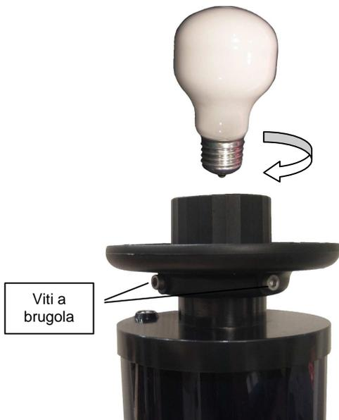
Fissare il portalampada sul coperchio mediante le 2 viti a brugola presenti sul lato (chiave da 5 mm)
