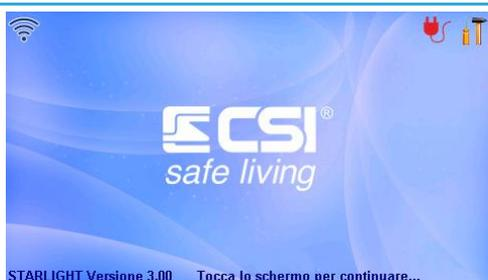
Dopo l'alimentazione, la prima videata che compare è lo splash-screen riportante la versione firmware del terminale (nell'esempio, 3.00). Per proseguire, è sufficiente premere delicatamente con la punta di un dito su una qualsiasi parte dello schermo; lo splash-screen scompare per lasciare il posto alla videata generica di stato
