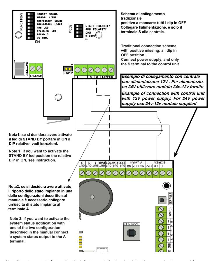
Nota: Per ottenere tutte le visualizzazioni di stato centrale, (inserito/disinserito, memoria allarme ecc.) è necessario che il dispositivo abbia collegato l'alimentazione (+ -). Quando viene a mancare l'alimentazione (funzionamento solo in batteria) non saranno attivate tali segnalazioni per una questione di ottimizzazione dei consumi. Mentre il lampeggio in caso di allarme è sempre garantito.
