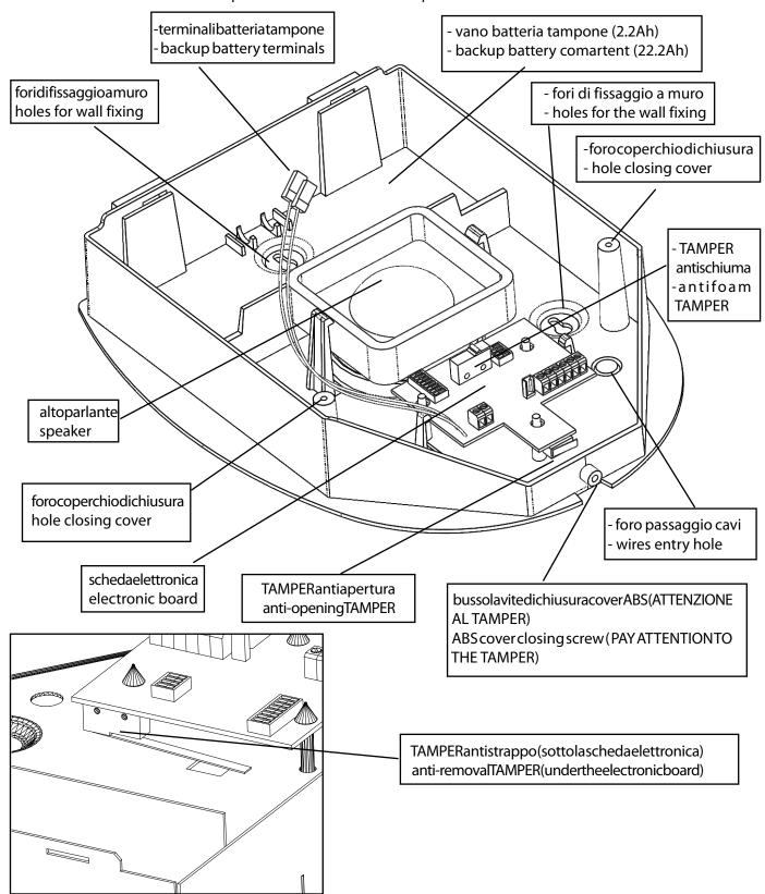
L'in stallazione a norma prevede l'utilizzo di una vite fissa ta amuro, la cui testa andr'a a premere il micros witch antirimozione, posiziona to sul la to inferiore della scheda.
