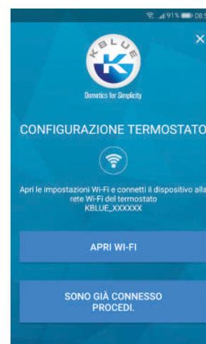
Una volta connessi alla rete direct si dovrà inserire il nome della rete WiFi e la password alla quale verrà connesso il cronotermostato. Configurare l'accesso tramite DHCP oppure inserendo un IP statico. Una volta confermate le impostazioni la procedura di modifica rete termina e il cronotermostato si conetterà alla nuova rete inserita.
