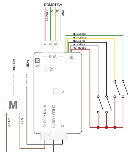
In figura un esempio di collegamento in modalità automatico di ETH-I42TR.
