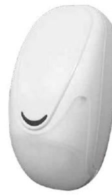
Sensore a doppia tecnologia PIR/MW con doppia analisi digitale, portata di circa 15 mt, angolo di apertura di 90°, piroelettrico doppio elemento, resistenze interne di fine linee EOL per singolo e doppio bilanciamento. Dotato di dispositivo tamper antiapertura, dispositivo antistrisciamento e conta impulsi. Comoda chiusura ad incastro senza viti. **Colori disponibili:** bianco
