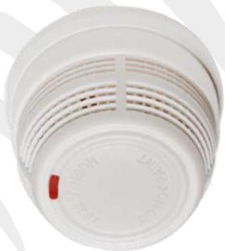
Il rivelatore ottico di fumo e temperature associa due principi di rivelazione distinti: la rivelazione di fumo, adatta per la rivelazione di incendi a lenta progressione dove possono trascorrere anche diverse ore prima che l'ambiente vada a fuoco, e la rivelazione del gradiente termico, in caso di incendi a rapida o media progressione. Copertura media: 50 mq.
