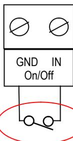
**Morsetto di sensing di stato della centrale IN On/Off**
