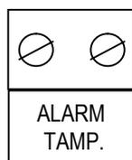
Il Controller è dotato di un'uscita NC per la segnalazione di allarme Tamper e/o Mascheramento.
