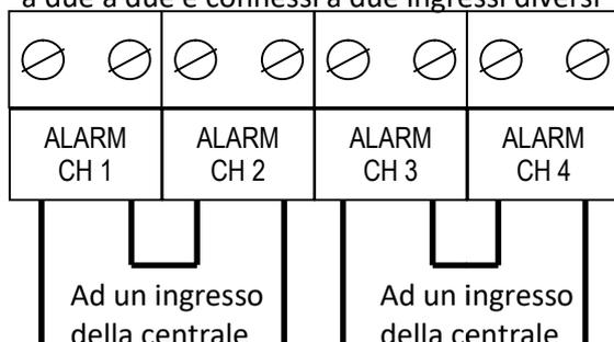
Esempio di connessione di 4 canali tutti in serie e connessi ad un unico ingresso
