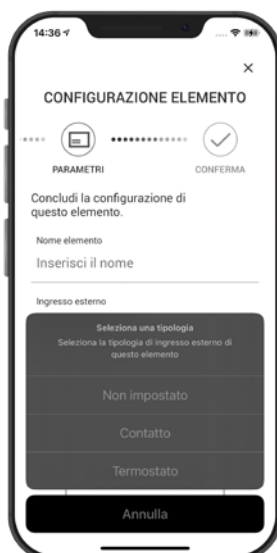
Fig.7 Funzione sonda di temperatura. Attribuire un nome all'elemento, quindi selezionare la tipologia di ingresso.
